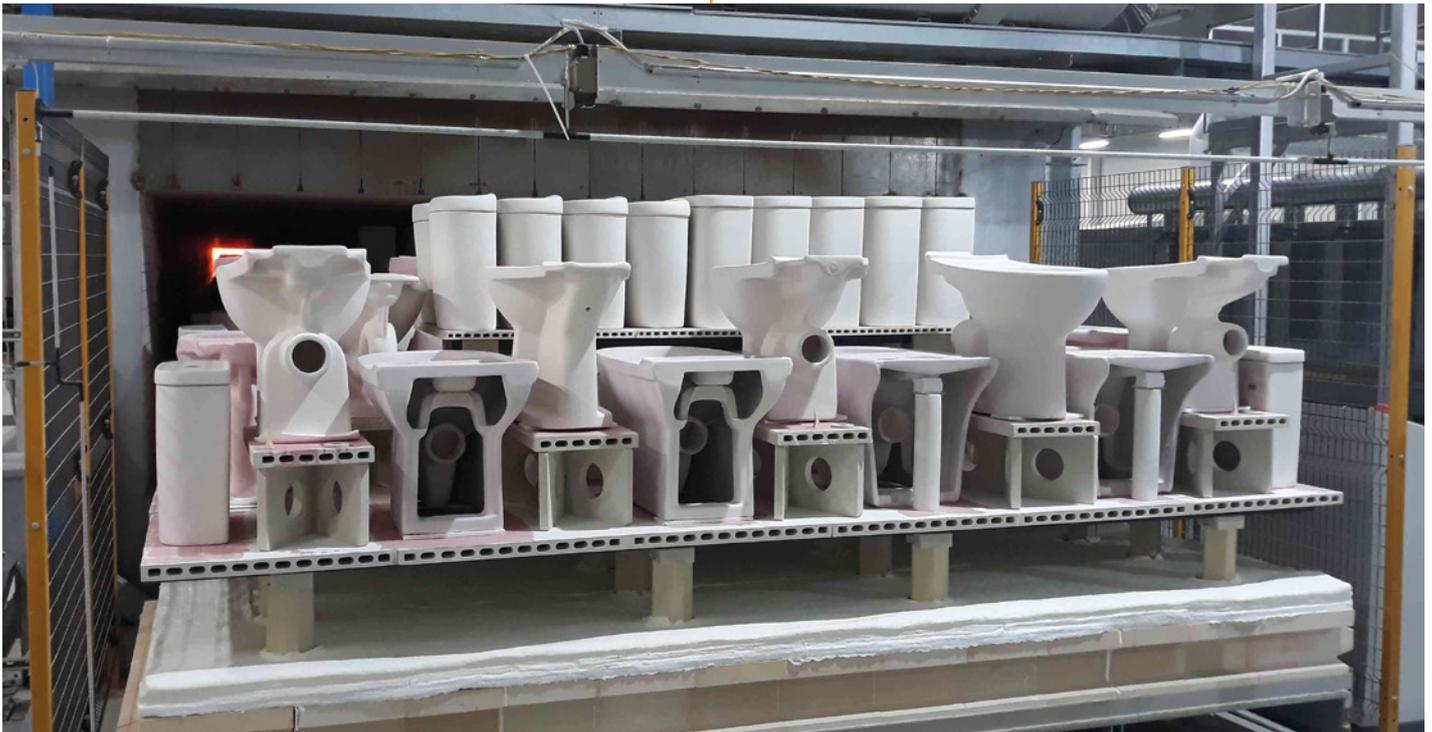
Kiln saturation with complex and varied production mixes ~ Saturazione del forno con mix produttivi complessi e diversificati
