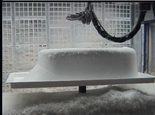
Los Robot para la aplicación de la fibra de vidrio constan de una pistola automática especial y de una cortadora Roving, ambas controladas mediante sistema Mass Control.
